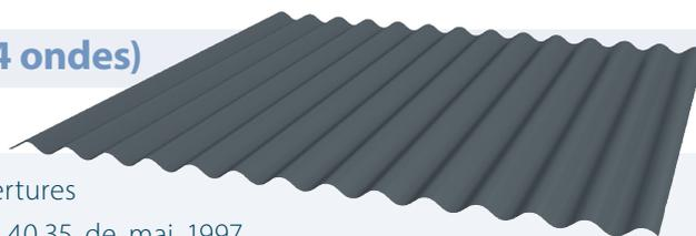
Jl 18-076-988 est une tôle profilée destinée aux couvertures sèches (le DTU 40.32 d'avril 1967 complété par le DTU 40.35 de mai 1997 précisent les situations et les pentes à respecter). La laque définie à la commande de Jl 18-076-988 est appliquée en face SO.
