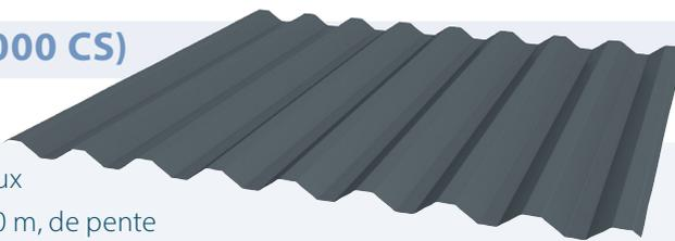
JI 25-125-1000 Toiture est une plaque nervurée destinée aux couvertures sèches pour des versants de longueur maxi 30 m, de pente courante minimale de 7% à 15% (le DTU 40.35 précise les situations qui correspondent à ces pentes). La laque définie à la commande de JI 25-125-1000 Toiture est appliquée en face SO.
